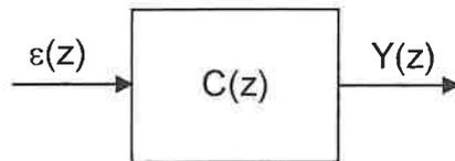
Avec  $\varepsilon(z)$  la transformée en z du signal d'écart (entrée) et  $Y(z)$  celle du signal de sortie.
